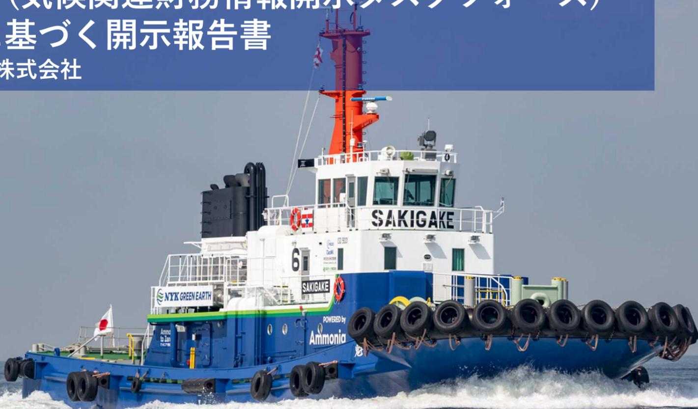
世界初のアンモニア燃料商用船(アンモニア燃料タグボート「魁」(さきがけ)) 8月23日竣工
