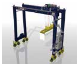
コンテナ貨物の荷役を行う門型の「トランスファークレーン」
