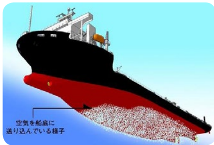
▲ 本システムを搭載したモジュール運搬船を下から見たイメージ図
