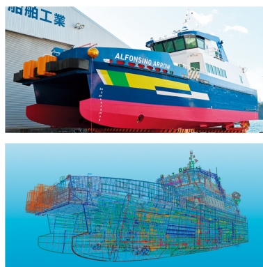
作業員輸送船 本船写真（上）と 3Dモデル（下）の比較
