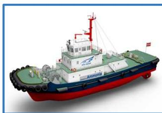
アンモニア燃料タグボート(内航船)の開発・運航
