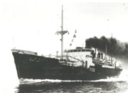
「小樽丸(Ⅲ世)」要目 全長：85.29m 総トン数：1,993.00トン 最高速力：17.436ノット 建造：三菱重工業(株)長崎造船所 竣工：1948(昭和23)年4月19日
