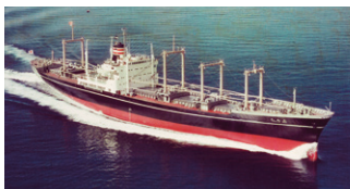
『山城丸』(Ⅲ世) 全長：161m 総トン数：10,032.23トン 速力：22.5ノット 建造：三菱造船(株)長崎造船所 竣工：1963年11月9日
