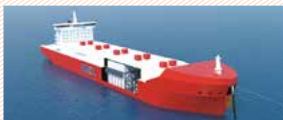
PCO 2 船（高圧CO 2 船）のイメージ。CO 2 を充填した数百本から千数百本のシリンダータンクを垂直に積載
