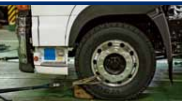
トレーラーが動かないよう 特殊な資材でしっかり固縛する
