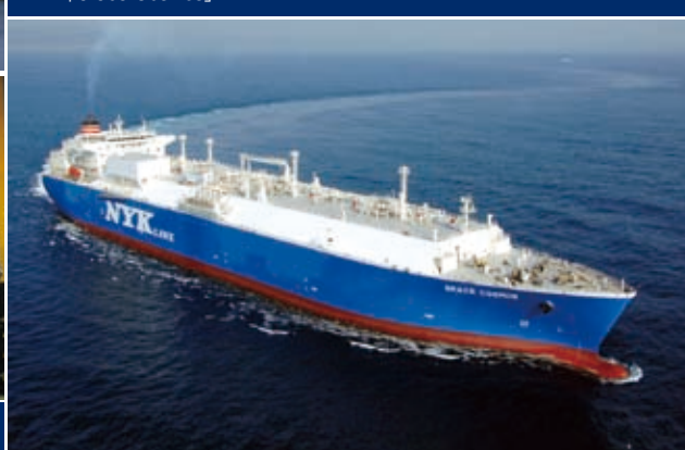
上/LNG船は通常1港積み1港揚げ。ターミナル入荷役作業に費やす時間は12時間程度とコンテナ船などに比べ短め 下/日本で馴染みが深いモス型に対して角形のメン「Grace Cosmos」 港後、約23時間停泊。テナ船などに比べ短め ブレン型LNG船
