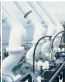
上 / LNG 船の荷役設備 左 / 陸上基地とパイプをつないで荷役作業を行う
