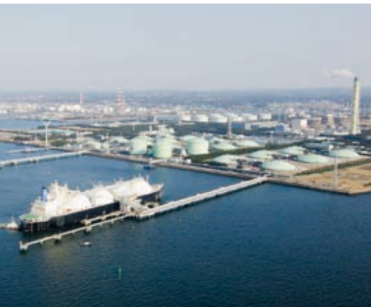
上 / LNG 船の荷役設備 左 / 陸上基地とパイプをつないで荷役作業を行う
