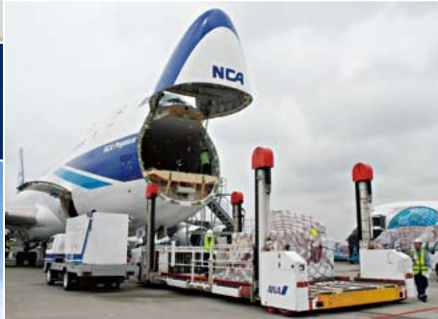
上／機体側面のサイドカーゴドア 下／機首が上方に開口するノーズカーゴドア
