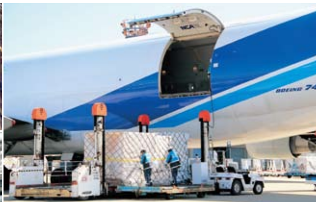
上／機体側面のサイドカーゴドア 下／機首が上方に開口するノーズカーゴドア
