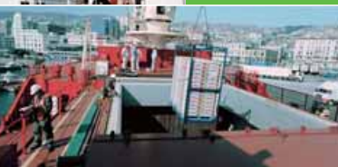
上・左・下/バナナの荷役風景。パレットに乗せ48箱をひとまとめにし、船上クレーンで船倉内へ
