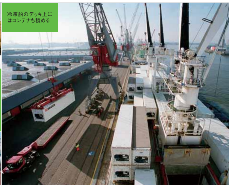
上・左・下/バナナの荷役風景。パレットに乗せ48箱をひとまとめにし、船上クレーンで船倉内へ
