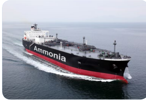
▲ アンモニア燃料アンモニア輸送船(AFAGC)
