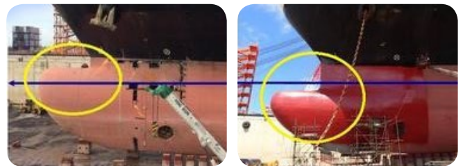
▲ 改造前 ▲ 改造後 バルバスバウの改造（船型や運航条件に併せてバルバスバウの形を改造）
