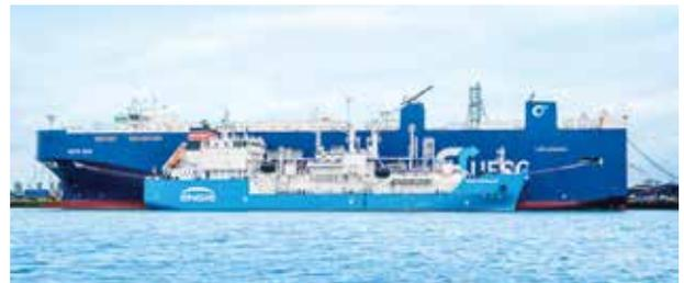
自動車専用船へのShip to Ship方式によるLNG燃料供給
